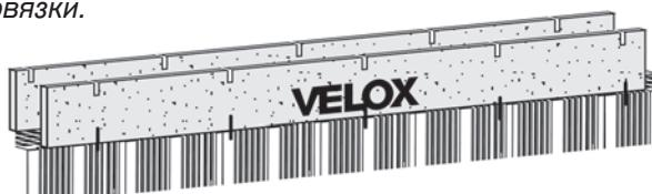
4. Установка односторонних концевых стяжек в заранее подготовленные шлицы на верхней стороне обвязочных плит в количестве 5 шт./2 п.м.
