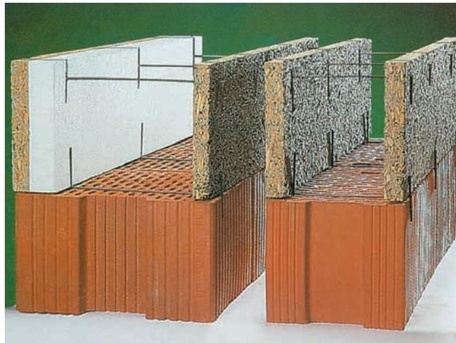
Обвязочные плиты VELOX это щепоцементные панели толщиной 35 мм в комбинации с теплоизоляцией 80 мм, предназначенные для двухсторонней опалубки обвязочной конструкции. В комбинации с теплоизоляцией происходит значительное ограничение тепловых мостов наружных обвязочных конструкций.
